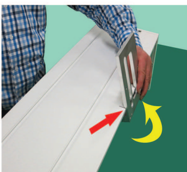
Frässhablone auf Deckelblende positionieren
