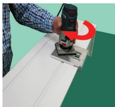
Ausfräsung vornehmen 10mm Fräser 20mm Anlauftring
