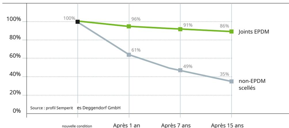
\* Comportement d'un joint lorsqu'il est comprimé à plusieurs reprises, par exemple ouverture et fermeture de la fenêtre. Une déformation de retour au contour d'origine est optimale. C'est le seul moyen de garantir un effet d'étanchéité durablement élevé.
